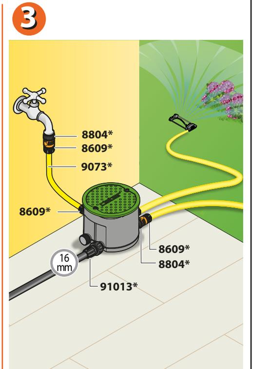
**Disegni di installazione indicativi. \* componenti non forniti, da acquistare a parte.**
